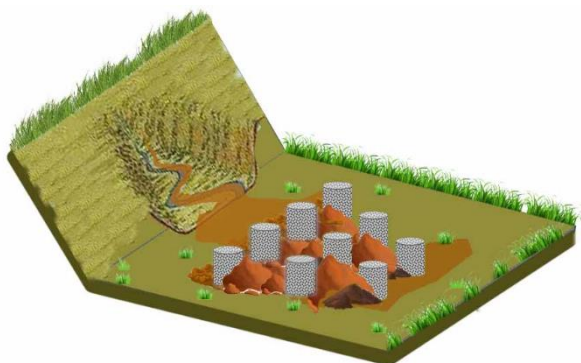
شکل ۶) نحوه عملکرد گروه پایه‌ها در کاهش اندازه حرکت ذرات درشت‌دانه جریان و توقف آنها در فضای بین پایه‌ها
